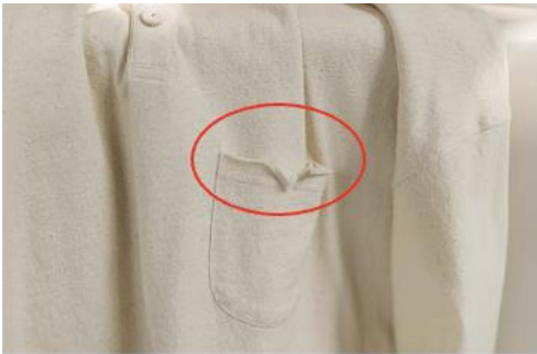
图 3-4 起皱问题实物拍摄图
